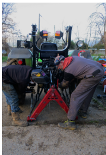
Figure 12 Montage du triangle d'attelage sur le tracteur de la ferme Agricole
